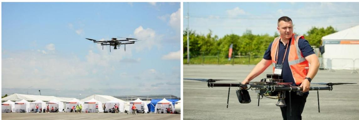
Фото. Летные испытания лазерного газоанализатора «Гимли» с базированием на аэродроме Пушистый (Сахалинская обл.) в период 16-17.07.2024г.
