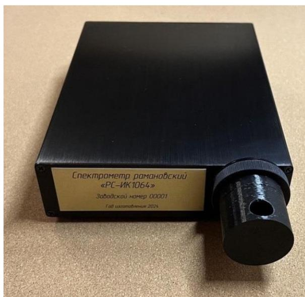
Фото: Опытный образец рамановского спектрометра ИК-диапазона.
